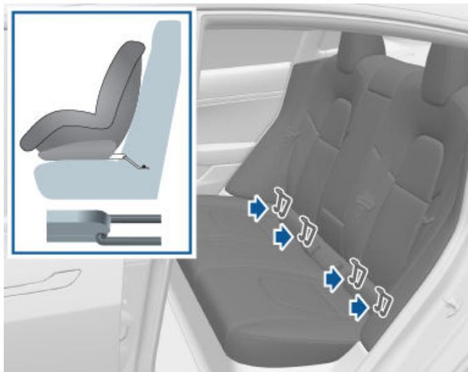
**REMARQUE :** Si le véhicule Model Y est doté de sept sièges, la troisième rangée de sièges n'est pas équipée d'ancrages LATCH. Pour la troisième rangée, utilisez uniquement des sièges de sécurité pour enfants retenus par ceinture de sécurité.
