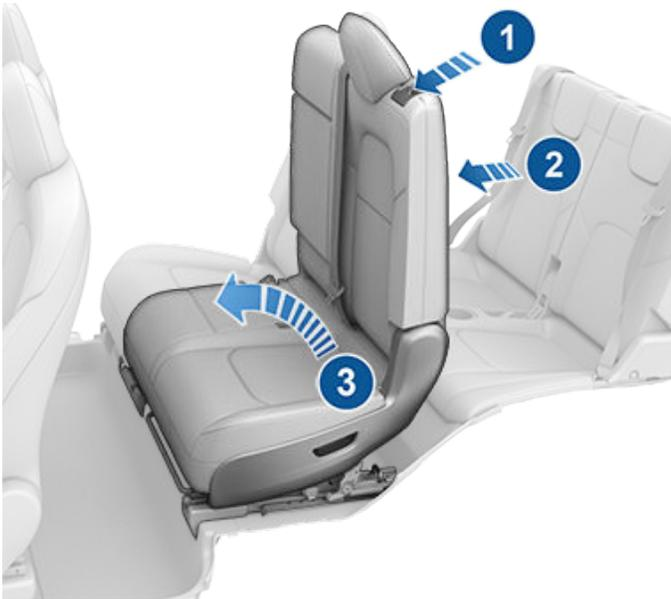
Pour verrouiller les sièges, poussez-les d'abord vers l'arrière. Vous entendrez la glissière de siège s'enclencher. Poussez ensuite le siège vers le bas pour enclencher les ancrages arrière dans les prises du plancher. Vous entendrez les ancrages s'enclencher. Si le siège ne s'enclenche pas, l'écran tactile affiche un avertissement à cet effet.
