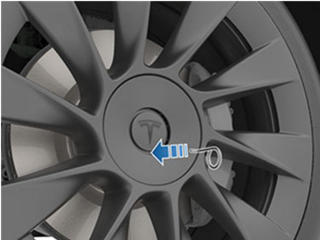
2. Tournez l'outil du cache d'écrou de façon à ce que l'extrémité de la partie incurvée soit dirigée dans la direction opposée au « T » de Tesla.
