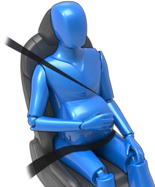
**⚠ AVERTISSEMENT :** Si la ceinture de sécurité est inconfortable, réglez la position du siège au lieu de porter la ceinture de sécurité de manière incorrecte.
