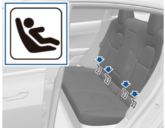
Pour la deuxième rangée, installez les sièges de sécurité pour enfants LATCH sur les sièges d'extrémité seulement. Sur le siège central, utilisez toujours un siège retenu par ceinture de sécurité.
