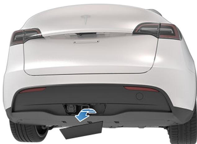
2. Si nécessaire, enlevez la goupille fendue du boulon de verrouillage et retirez ce dernier de l'attelage.
