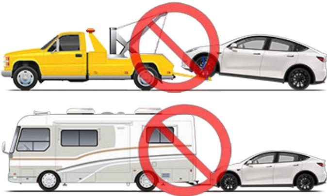
Ne transportez jamais le véhicule Model Y par une méthode autre que celle indiquée par Tesla. Suivez les instructions fournies dans les sections suivantes et conformez-vous à toutes les mises en garde et précautions indiquées. Les dommages dus à un transport inadéquat de votre véhicule ne sont pas couverts par la garantie.
