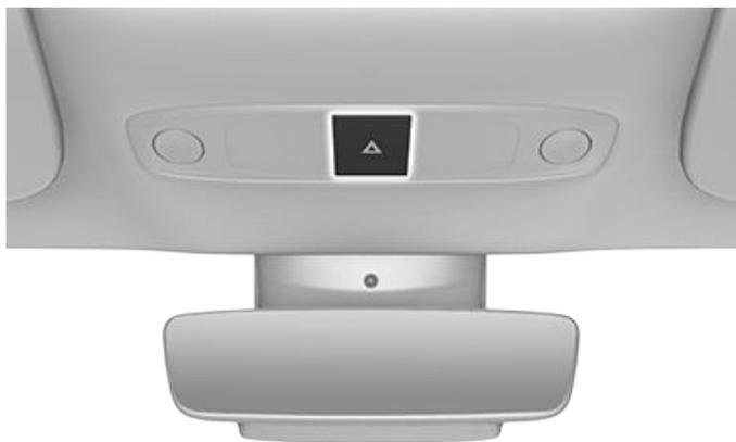
Si votre véhicule détecte un accident grave, les feux de détresse s'allument automatiquement et clignotent rapidement pour accroître la visibilité. Le fait d'appuyer une fois sur les feux de détresse ramène les feux à leur cadence normale. En appuyant une deuxième fois, tous les feux de détresse s'éteignent.
