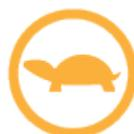
L'alimentation du véhicule est limitée parce qu'il y a peu d'énergie restante dans la batterie, que les systèmes du véhicule sont en période de réchauffement ou de refroidissement ou qu'une erreur a été détectée par le convertisseur d'entraînement.
