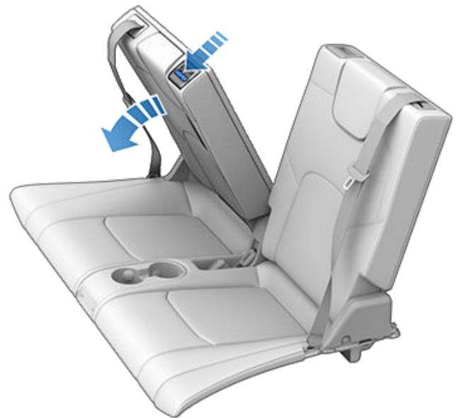
**REMARQUE :** Pour replacer les dossiers en position verticale, remontez-les jusqu'à ce qu'ils se verrouillent en position. Essayez de tirer le dossier vers l'avant pour confirmer qu'il est verrouillé sécuritairement en position verticale.
