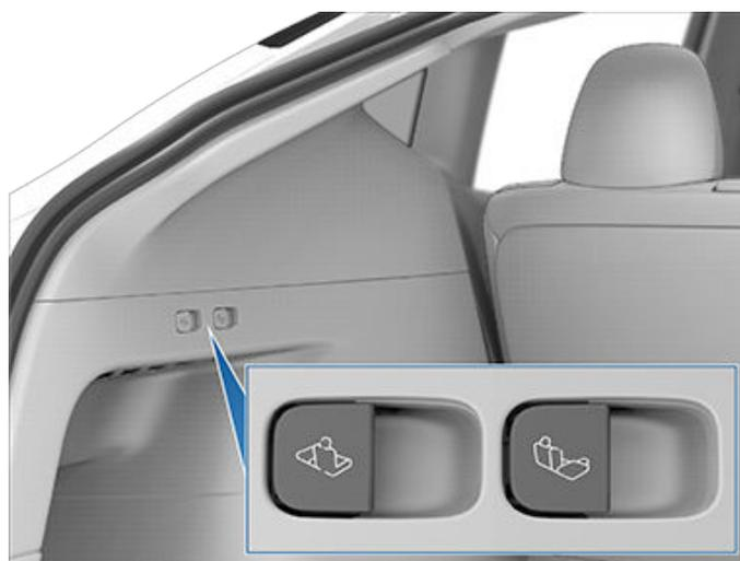
**⚠ AVERTISSEMENT :** Avant d'appuyer sur le commutateur servant à coucher le dossier du siège, vous DEVEZ vous assurer qu'aucun objet ou partie du corps (mains, doigts, etc.) ne se trouvent sur les rebords des sièges arrière. Le siège peut basculer vers l'avant avec une force considérable et causer des blessures et des dommages.
