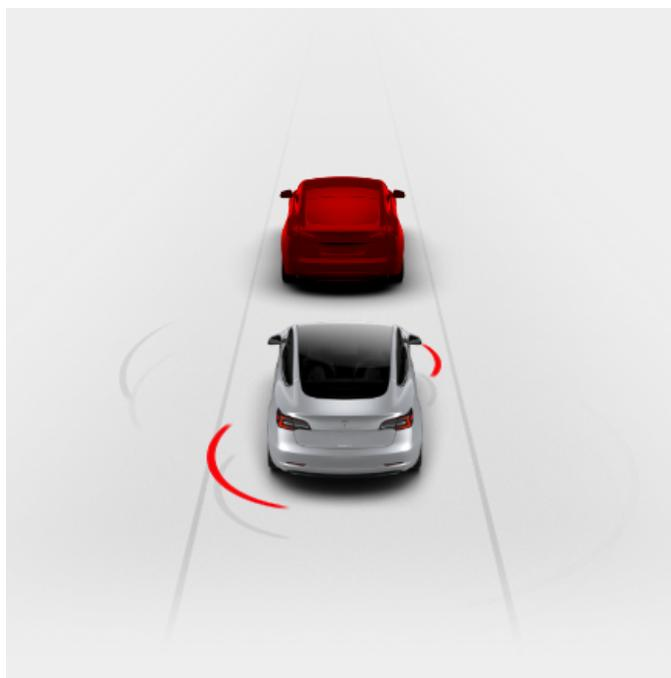
Les avertissements visuels, sonores et tactiles s'arrêtent automatiquement lorsque le risque de collision s'est dissipé (par exemple, si vous avez décéléré ou arrêté le véhicule Model Y ou si l'objet devant votre véhicule a quitté votre voie).
