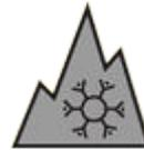
Les pneus d'hiver sont marqués d'un symbole de flocon et de montagne sur le flanc.
