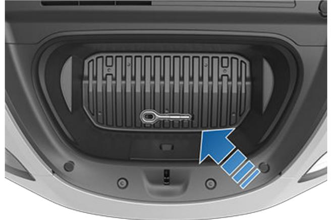
2. Dégagez le cache anneau de remorquage à l'avant ou à l'arrière en appuyant fermement sur sa partie supérieure droite jusqu'à ce qu'elle pivote vers l'intérieur, puis tirez délicatement sur la section relevée.
