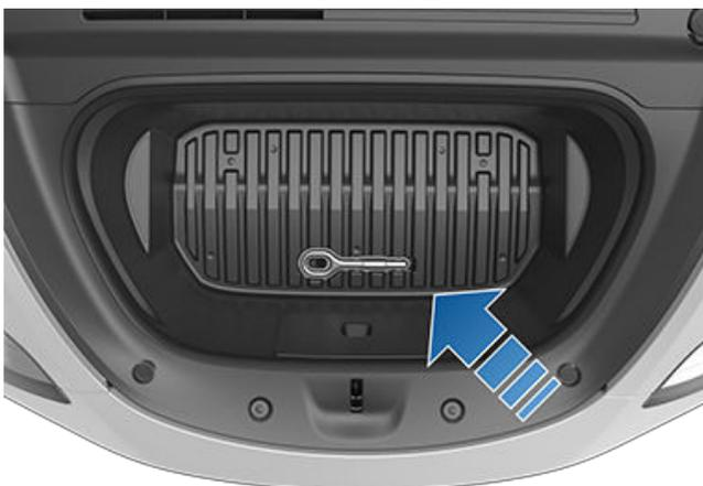
2. Dégagez la protection de l'œil de dépannage arrière en appuyant fermement sur sa partie supérieure droite jusqu'à ce qu'elle pivote vers l'intérieur, puis en tirant délicatement sur la section relevée.
