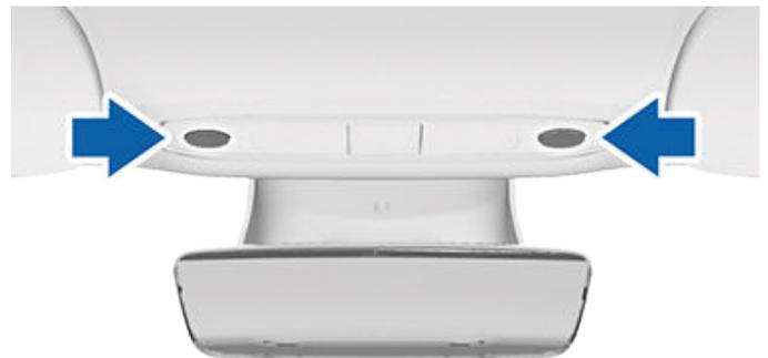
Vous pouvez également allumer ou éteindre manuellement un seul plafonnier en appuyant sur sa lentille. Si vous allumez un plafonnier manuellement, il s'éteint lorsque l'alimentation du Model Y est coupée. Si le véhicule Model Y était déjà hors tension lorsque vous avez allumé manuellement l'éclairage, ce dernier s'éteint après un certain laps de temps.
