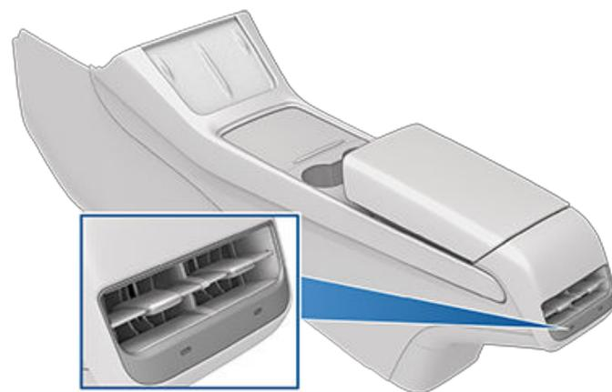
Si le véhicule Model Y a sept sièges, il est doté de deux ports USB-C dans le devant de la console située entre les sièges de troisième rangée. Ces ports peuvent servir à recharger des appareils compatibles USB, mais ils ne peuvent communiquer avec le véhicule.
