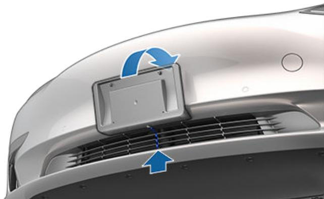
6. Retirez le reste du ruban sur les côtés du support, puis poussez fermement le support en entier contre le pare-chocs, en vous assurant que le support est bien maintenu en place grâce à toutes les surfaces adhésives.
