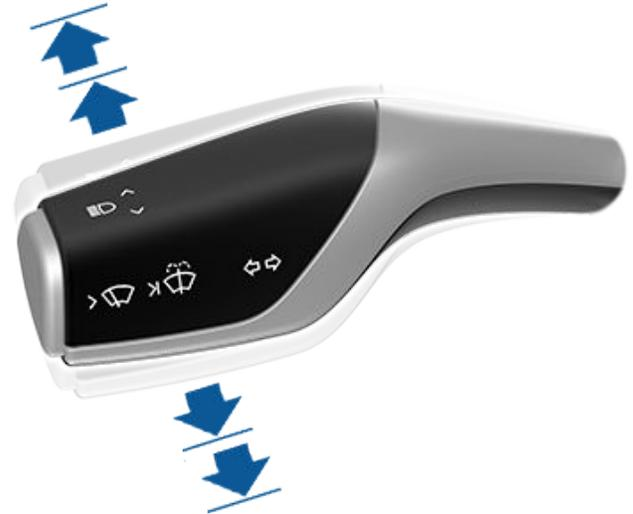
Les feux clignotants cessent de fonctionner s'ils sont annulés par le volant à sa position initiale, en poussant le levier dans la direction opposée ou en le poussant doucement, une fois de plus, dans la même direction.
