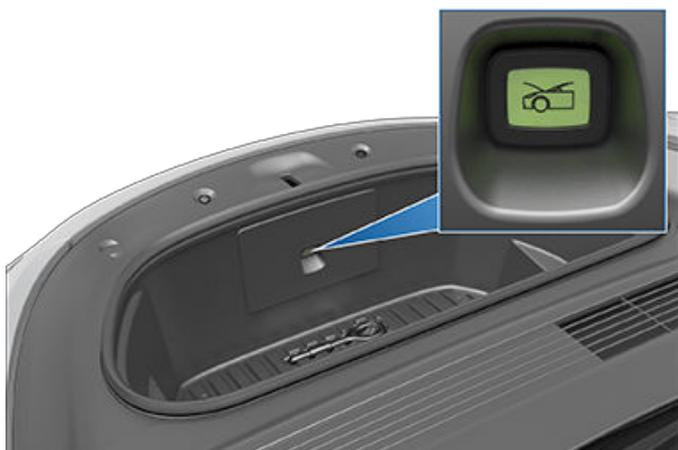
Appuyez sur le bouton de relâchement intérieur pour déverrouiller le coffre avant, puis levez le capot.
