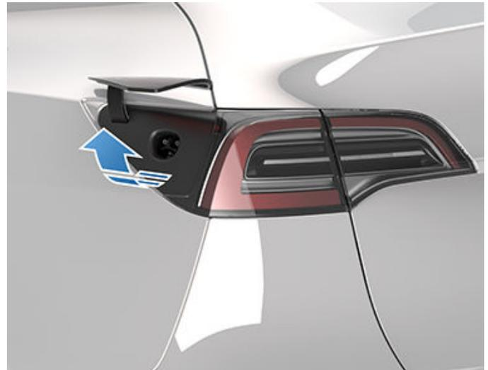
**REMARQUE :** Le « T » de Tesla s'illumine lorsque vous ouvrez la porte du port de recharge. Si vous n'insérez pas de câble de charge dans la prise de recharge quelques minutes après l'ouverture de la porte de la prise de recharge, cette dernière se ferme. Dans ce cas, utilisez l'écran tactile pour rouvrir la trappe de la prise de recharge.
