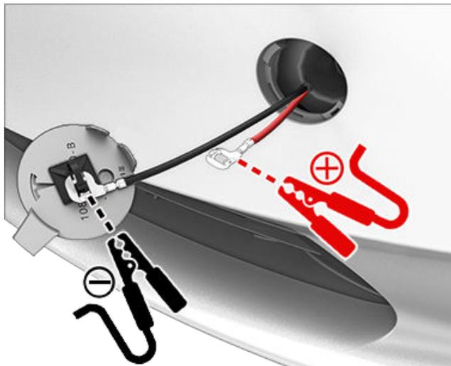
**REMARQUE :** Appliquer une source externe d'alimentation basse tension à ces bornes libérera uniquement les loquets du capot. La batterie basse tension ne peut pas être rechargée à l'aide de ces bornes.
