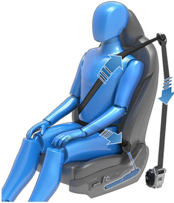
Si les prétendeurs et les coussins gonflables n'ont pas été activés lors d'un impact, cela n'est pas un signe de défaillance. Cela signifie généralement que l'intensité ou le type de force ne suffisaient pas pour les activer.
