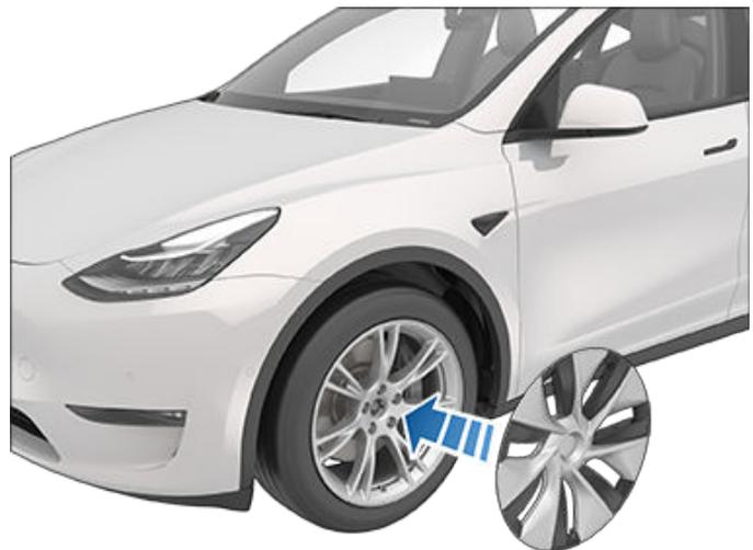
Pour les roues Gemini, appuyez sur le périmètre du couvercle jusqu'à ce qu'il s'aligne avec la surface de la roue. Appuyez sur le « T » de Tesla dans le centre jusqu'à ce que le couvercle s'enclenche en place. Voir [Pièces et accessoires](#) pour en savoir plus.
