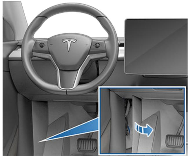
3. Retirez le tapis pour exposer le connecteur à 4 broches du véhicule sur le faisceau de câbles.
