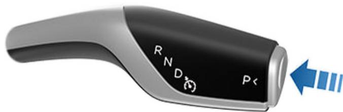
Model Y se met automatiquement en position de stationnement afin d'éviter tout risque de dérapage à basse vitesse. Cela se produit lorsque vous connectez un câble de charge, débouclez votre ceinture de sécurité ou ouvrez la portière lorsque vous êtes en position de conduite ou de stationnement. Assurez-vous que le câble de charge est retiré, bouclez votre ceinture de sécurité et fermez la portière avant de sortir de la position de stationnement.
