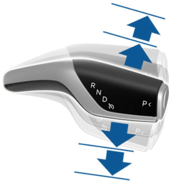
Si vous essayez de passer un mode interdit en raison de la vitesse de conduite, un signal sonore retentit et le mode de conduite reste le même.
