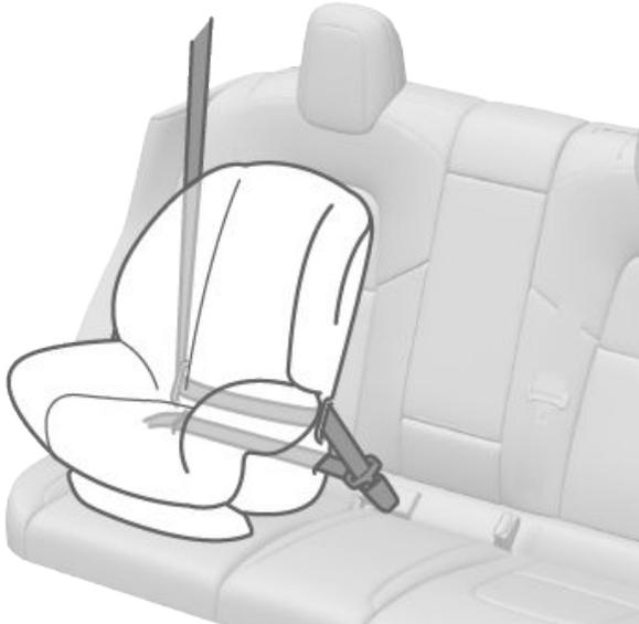
2. Laissez la ceinture de sécurité s'enrouler et enlevez le jeu de la ceinture de sécurité tout en poussant fermement le siège de sécurité pour enfants dans le siège du véhicule Model Y.
